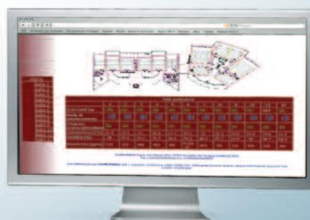
El microprocesador permite la total interconexión con el sistema de Supervisión que incluye los sistemas de seguridad, desde el control y regulación de los parámetros de funcionamiento hasta la representación gráfica del funcionamiento de la unidad, junto con el historial de alarmas y los puntos de control.
